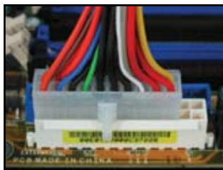
Connecteur d'alimentation 20 broches (branché sur la prise femelle 24 broches de la carte mère)
