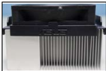
Vue de côté du dissipateur et du ventilateur
