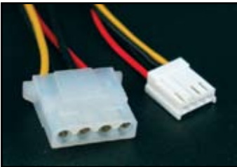
Connecteur d'alimentation périphérique (à gauche) Connecteur pour lecteur disquettes (à droite)
