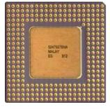
Quand le nombre de contacts a augmenté, la forme des boîtiers est devenue carrée et les constructeurs ont placé les contacts dans une disposition quadrillée. Cela a donné les connecteurs dits PGA pour *Pin Grid Array* (matrice à grille de broche). Il a finalement du être nécessaire de placer les contacts en quinconce pour pouvoir en disposer plus sur une même surface. On parle alors de SPGA pour *Staggered Pin Grid Array* (matrice à grille de contacts en quinconce).
