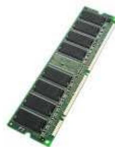
Les DIMM SDRAM ont 168 contacts (84 par face) Deux encoches servent de détrompeurs. Elles sont généralement alimentées en 3,3V mais il existe d'autres tensions d'alimentation. Ces variantes sont signalées par de petites modifications des positions des détrompeurs empêchant ainsi l'insertion d'une barrette prévue pour 3,3V dans un socket prévu pour alimenter des barrettes en 5V.
