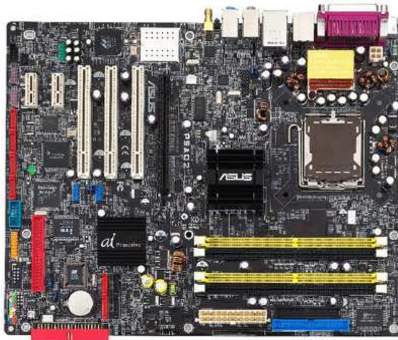
Pour être gérées en mode « Dual Channel », les barrettes identiques (même capacité et même fréquence) doivent être montées dans des supports appariés.
