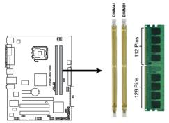
P5GC-MX/1333 240-pin DDR2 DIMM Sockets
